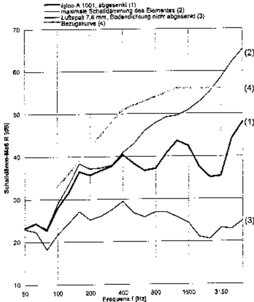
Zur Beurteilung der erzielten Schalldämmung ist die Bezugskurve (4) für Terzbänder nach DIN EN ISO 717-1 - Bewertung der Schalldämmung in Gebäuden und von Bauteilen, Teil 1: Luftschalldämmung (ISO 717-1: 1996) Deutsche Fassung EN ISO 717-1: 1996 - Ausgabe Januar 1997 in das Diagramm mit eingetragen.
